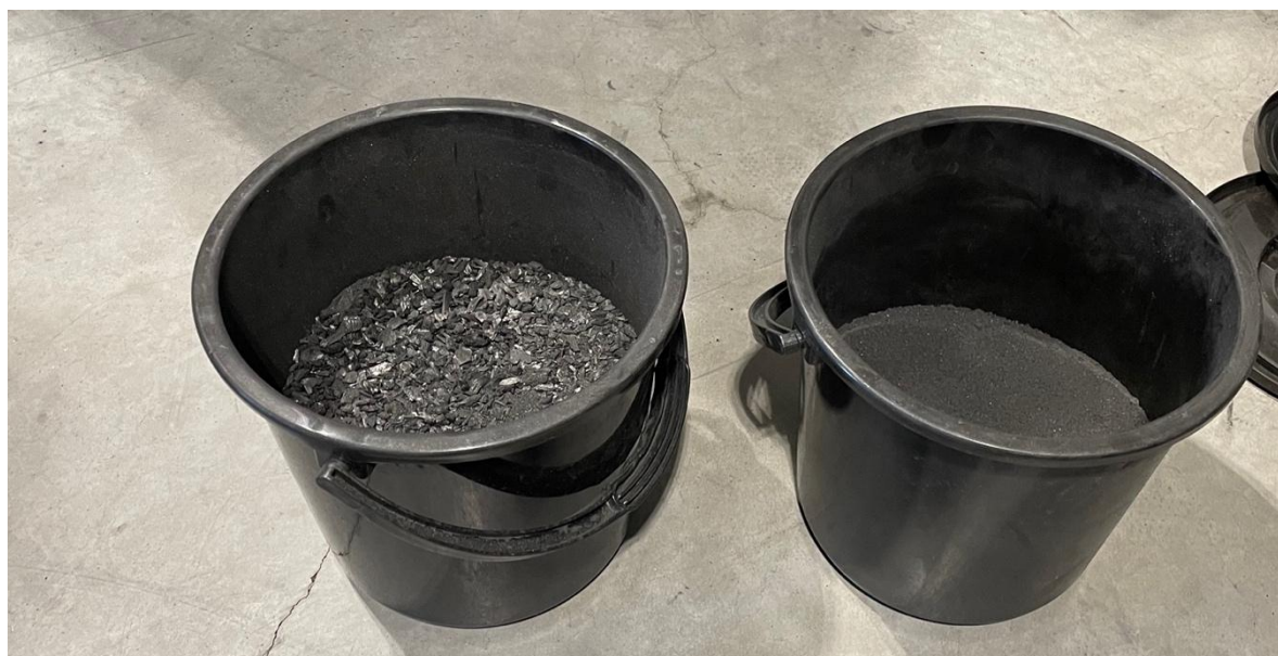
Figur 1: Biokull i fin og grov sortering. Bildet er tatt på studieturen til Opplandske bioenergis biokullanlegg på Rudshøgda. Foto: Torunn Hønsi.
