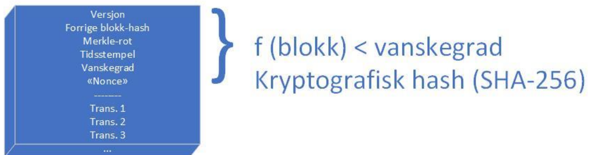
Figur 3: Innholdet i ei blokk, og den delen som er utgangspunktet for den matematiske rekneoppgåva (hash-funksjon). Variabelen «nonce» er berre ein teljar som kan endrast for å få ein ny hash-verdi, den har ingen annan funksjon.
